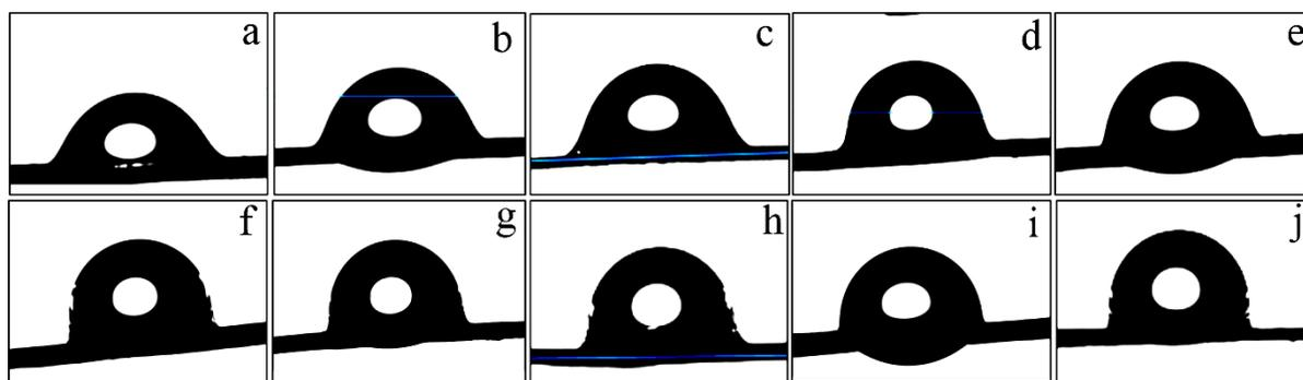
Figure 3: Images of the angle formed on the sisal fiber : a) Natural Fiber, b) Washed Fiber, c) 1.A.10.1, d) 1.A.10.5, e) 1.A.40.1, f) 1.A.40.5, g) 3.A.10.1, h) 3.A.10.5, i) 3.A.40.1, j) 3.A.40.5.
